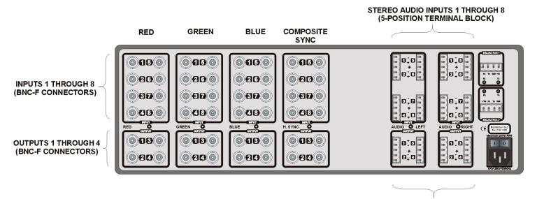
STEREO AUDIO OUTPUT 1 THROUGH 4 (5-POSITION TERMINAL BLOCK)
